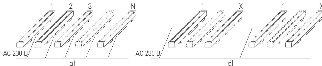
Рисунок 2. Схемы подключения прожекторов (А — параллельное, Б — последовательно-параллельное)
